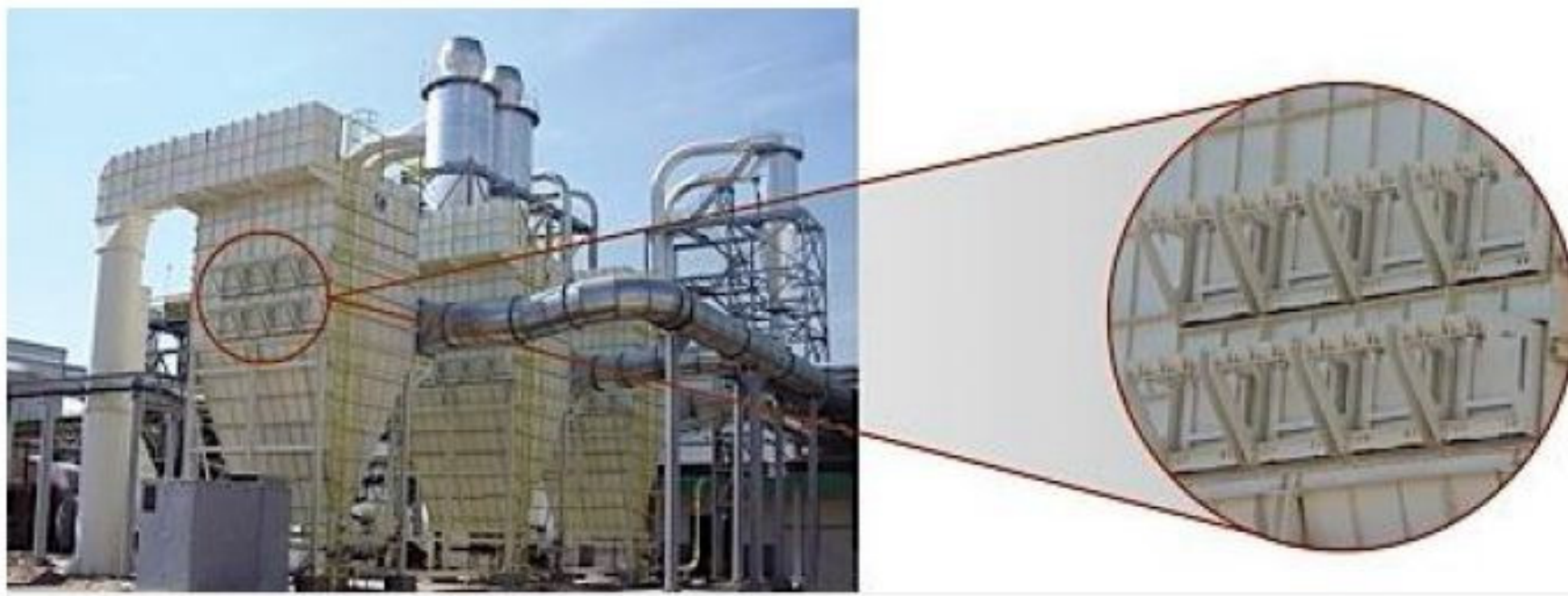
Figura 18: Elemento de alívio de pressão (BERNAUER, 2005)
